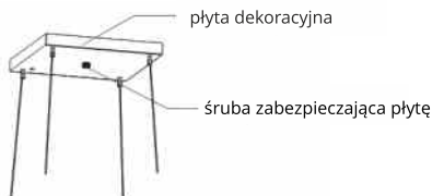
Rysunek 5. Montaż dekoracyjnej płyty na panelu mocującym
